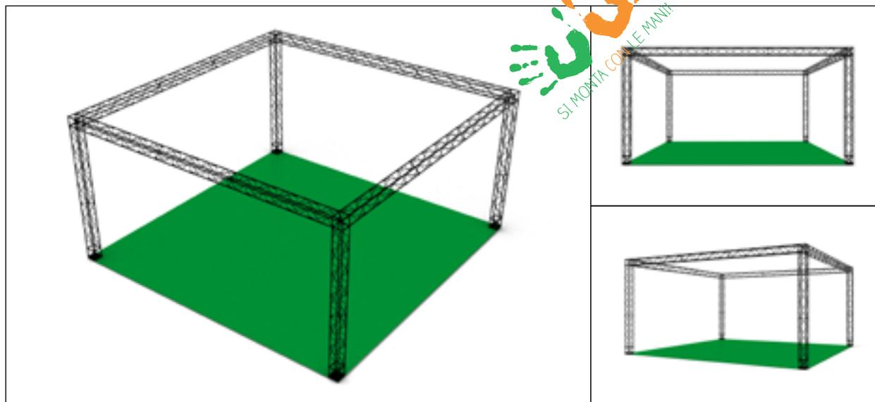
**Stand Ragno 600**, di formato cm 600x600x300H (misura esterna). Aperto su tutti i lati, ingresso utile cm 560 + altezza entrata utile di cm 280. Composto da tralicci lunghi: il più lungo utilizzato è da cm 200. Dotato di n.4 basi corte 20x20cm. Attenzione: con l'uso delle basi l'ingombro a terra sarà cm 600x600x301H (le basi 20x20 sono alte 1cm).
