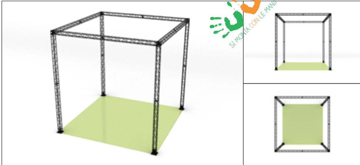
**Stand Ragno 300**, di formato cm 300x300x300H (misura esterna). Aperto su tutti i lati, ingresso utile cm 280 + altezza entrata utile di cm 280. Composto da tralicci corti: il più lungo utilizzato è da cm 140. Dotato di n.4 basi corte 16x16cm. Attenzione: con l'uso delle basi l'ingombro a terra sarà cm 306x306x302H (le basi 16x16 sporgono di 3cm per lato e sono alte 2cm).
